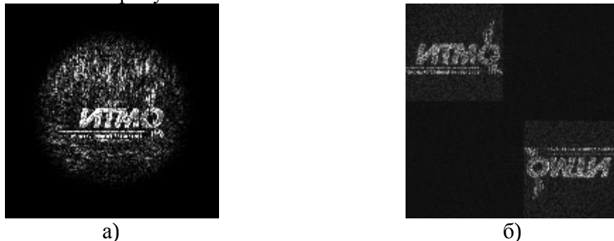
Рисунок. Результат восстановления водяного знака: а) на основе голограммы Френеля, б) на основе голограммы Фурье
