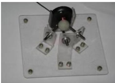
Рисунок. Фотография макета трех координатной поворотной платформы
